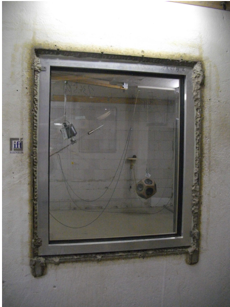
Bild 1 Fotos des eingebauten Elementes, erstellt vom ift Labor Bauakustik
